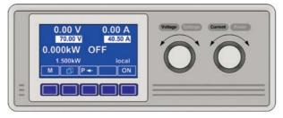
Über die interaktiven Bedientasten werden die im Display angezeigten Funktionen nach einer Betätigung ausgeführt.
