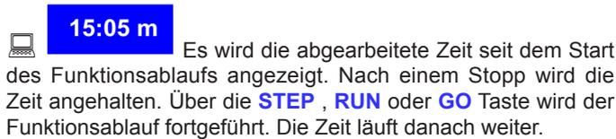
Es wird die abgearbeitete Zeit seit dem Start des Funktionsablaufs angezeigt. Nach einem Stopp wird die Zeit angehalten. Über die **STEP**, **RUN** oder **GO** Taste wird der Funktionsablauf fortgeführt. Die Zeit läuft danach weiter.
