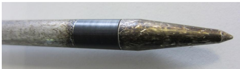
Verunreinigte Elektrodenspitze -> misst falsch!
