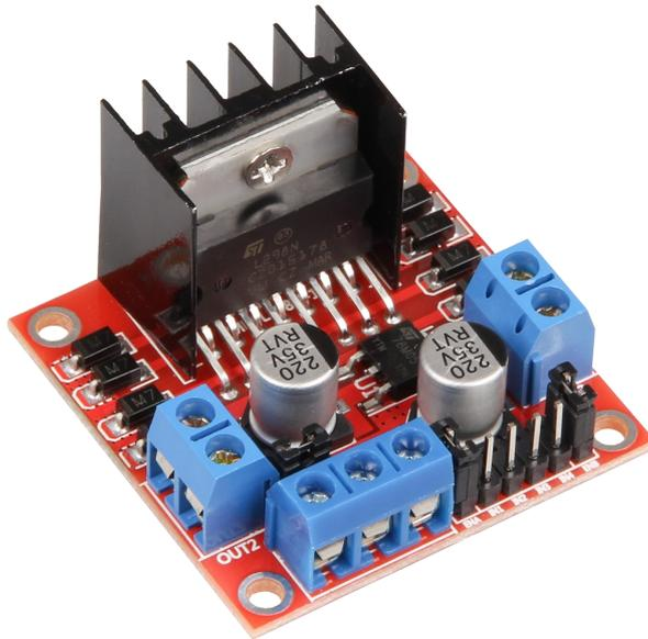
Der MotoDriver2 ist eine Erweiterungsplatine die schnell und einfach an Ihren Einplatinencomputer angeschlossen werden kann und sowohl die Steuerung, als auch die Stromversorgung von zwei Gleichstrommotoren ermöglicht.
