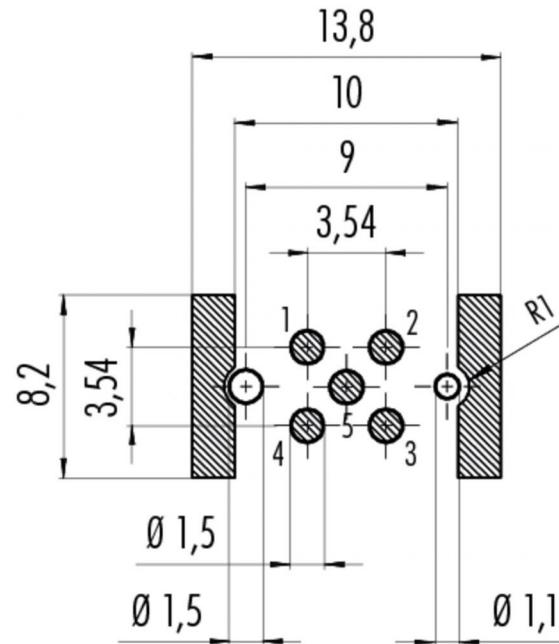
Bezeichnung **Polazhl: 5, Einbaudose, SMT, mit Gehäuse, schirmbar**
