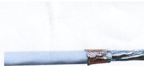
3. Das Kupferfolienband um Schirmgeflecht und Beidraht kleben, entfernen Sie überstehende Drähte.
