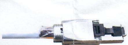
7. Die Steckerabdeckung schließen und sicherstellen, dass Beidraht/Kupferfolienband Kontakt zum Gehäuse hat.
