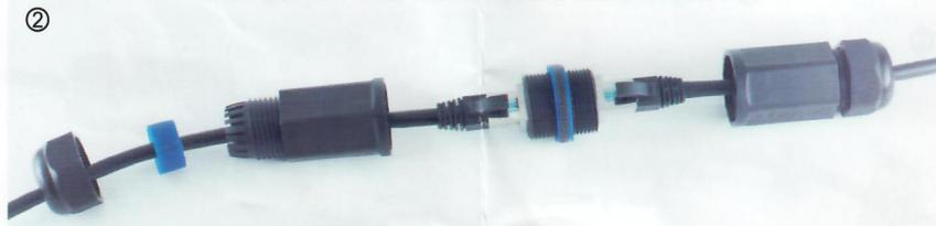
② Schließen Sie Ihre Patchkabel an den RJ45-Verbinder im Zentralstück an, montieren Sie den Tubus auf das Zentralstück, bringen Sie den Wasserfesten Verschluss auf das Kabel an und schieben Sie ihn danach in den Tubus. Verschließen Sie den Verbinder, in dem Sie die Endstücke (die Verschlusskappe) auf den Tubus montieren.
