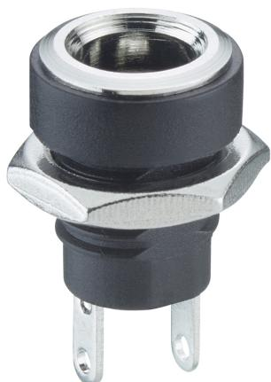
Netzgeräte-Einbaukupplung, gerade Ausführung, mit Lötaugen, für Leiterplatten, für Frontmontage
