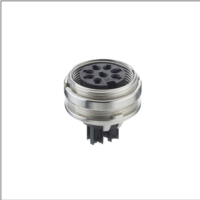
Einbaukupplung nach IEC 61076-2-106, IP40, mit Schraubverschluss, Leergehäuse für die Aufnahme von Crimpkontakten, für Rückseitenmontage
