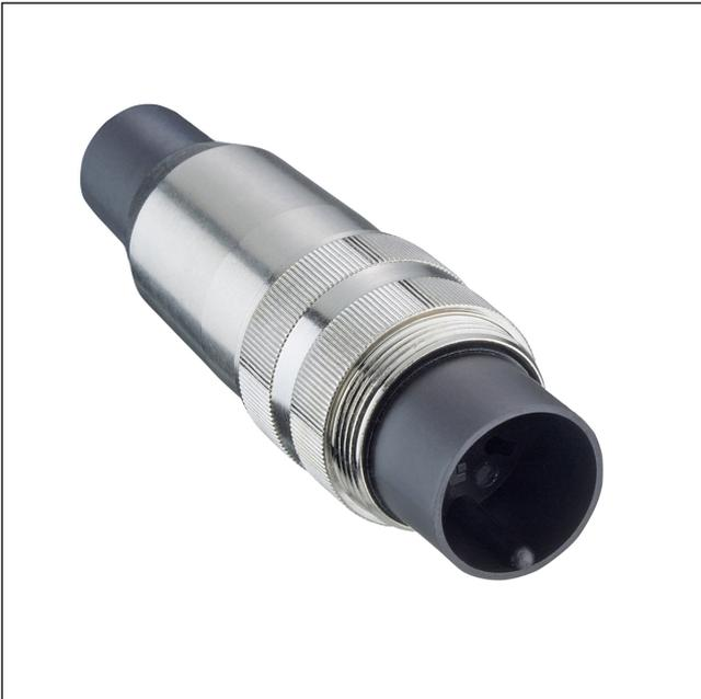
Stecker nach IEC 61076-2-106, IP40, gerade Ausführung, mit Schraubverschluss, Leergehäuse für die Aufnahme von Crimpkontakten, mit Knickschutztülle, für Kabeldurchmesser bis 8 mm
