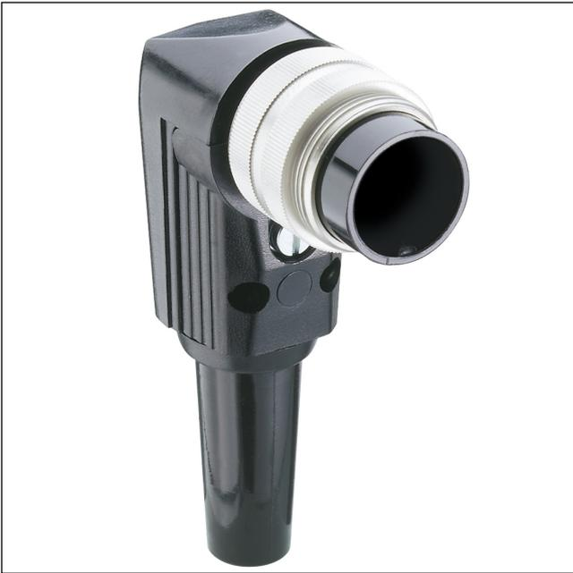
Stecker nach IEC 61076-2-106, IP40, abgewinkelte Ausführung, mit Schraubverschluss, Leergehäuse für die Aufnahme von Crimpkontakten, mit Knickschutzülle, für Kabeldurchmesser bis 6 mm
