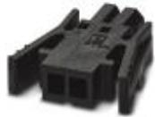
Leiterplattenstecker, Nennstrom: 6 A, Bemessungsspannung (III/2): 160 V, Nennquerschnitt: 0,75 mm<sup>2</sup>, Polzahl: 5, Rastermaß: 2,5 mm, Anschlussart: Crimpanschluss, Farbe: schwarz, Kontaktobерfläche: Zinn
