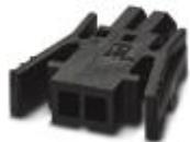
Leiterplattenstecker, Nennstrom: 6 A, Bemessungsspannung (III/2): 160 V, Nennquerschnitt: 0,75 mm<sup>2</sup>, Polzahl: 4, Rastermaß: 2,5 mm, Anschlussart: Crimpanschluss
