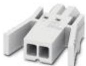
Leiterplattenstecker, Nennstrom: 6 A, Bemessungsspannung (III/2): 160 V, Nennquerschnitt: 0,75 mm<sup>2</sup>, Polzahl: 2, Rastermaß: 2,5 mm, Anschlussart: Crimpanschluss, Farbe: weiß, Kontaktoberfläche: Zinn
