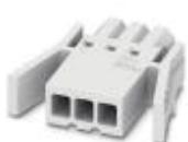
Leiterplattenstecker, Nennstrom: 6 A, Bemessungsspannung (III/2): 160 V, Nennquerschnitt: 0,75 mm<sup>2</sup>, Polzahl: 3, Rastermaß: 2,5 mm, Anschlussart: Crimpanschluss, Farbe: weiß, Kontaktoberfläche: Zinn
