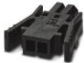
Leiterplattenstecker, Nennstrom: 6 A, Bemessungsspannung (III/2): 160 V, Nennquerschnitt: 0,75 mm<sup>2</sup>, Polzahl: 3, Rastermaß: 2,5 mm, Anschlussart: Crimpanschluss
