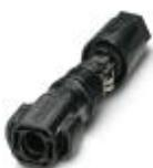
Photovoltaik-Steckverbinder, Artikelfamilie: PV-CM-S, Steckverbinder, Material Gehäuse: PPE, Farbe: schwarz, Polzahl: 1, Aderquerschnitt min.: 2,5 mm<sup>2</sup>, Aderquerschnitt max.: 6 mm<sup>2</sup>, Bemessungsstrom: 27 A, Anschlussart: Federkraft, Kontaktart: Stift. nur mit Werkzeug entriegelbar
