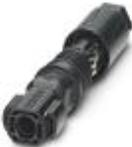
Photovoltaik-Steckverbinder, Artikelfamilie: PV-CM-S, Steckverbinder, Material Gehäuse: PPE, Farbe: schwarz, Polzahl: 1, Aderquerschnitt min.: 6 mm<sup>2</sup>, Aderquerschnitt max.: 16 mm<sup>2</sup>, Bemessungsstrom: 40 A, Anschlussart: Federkraft, Kontaktart: Stift. nur mit Werkzeug entriegelbar
