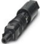
Photovoltaik-Steckverbinder, Artikelfamilie: PV-CF-S, Steckverbinder, Material Gehäuse: PPE, Farbe: schwarz, Polzahl: 1, Aderquerschnitt min.: 6 mm<sup>2</sup>, Aderquerschnitt max.: 16 mm<sup>2</sup>, Bemessungsstrom: 40 A, Anschlussart: Federkraft, Kontaktart: Buchse. nur mit Werkzeug entriegelbar
