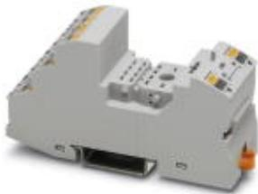
RIF-2.../EX Relaissockel zur Bestückung mit RTIII-gedichteten Industrirelais mit 4-Wechslern für den Einsatz in der Zone 2, Push-in-Anschluss, Steckmöglichkeit für Eingangs-/Entstörmodule, zur Montage auf NS 35/7,5
