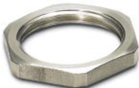
Protimatice, Ušlechtilá ocel 1.4305, pro závit M20 x 1,5, barva: stříbrná
