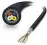
Netzwerkkabel, PROFINET CAT5 (100 MBit/s), 4-polig, PE-X halogenfrei, schwarz RAL 9005, geschirmt, freies Leitungsende, auf freies Leitungsende, Kabellänge: Freie Eingabe (0,5 ... 100 m), für Bahnanwendungen
