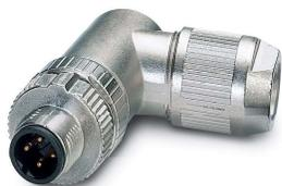
Datensteckverbinder, PROFINET CAT5 (100 MBit/s), 4-polig, geschirmt, Stecker gewinkelt M12, Kodierung: D, Push-Lock-Federanschluss, Rändelmaterial: Zinkdruckguss, vernickelt, Kabelaußendurchmesser 4 mm ... 8 mm
