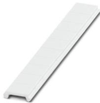
Zackband flach, Streifen, weiß, unbeschriftet, beschriftbar mit: CMS-P1-PLOTTER, PLOTMARK, Montageart: verrasten, für Klemmenbreite: 4 mm, Schriftfeldgröße: 4,2 x 5,2 mm, Anzahl der Einzelschilder: 10
