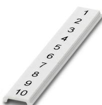
Zackband flach, Streifen, weiß, beschriftet, quer bedruckt: fortlaufende Zahlen 1 ... 10, 11 ... 20 usw. bis 91 ... 100, Montageart: verrasten, für Klemmenbreite: 4 mm, Schriftfeldgröße: 4,2 x 5,2 mm, Anzahl der Einzelschilder: 10
