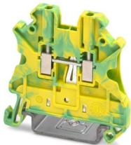
Schutzleiter-Reihenklemme, Anzahl der Anschlüsse: 2, Anschlussart: Schraubanschluss, Bemessungsquerschnitt: 1,5 mm<sup>2</sup>, Querschnitt: 0,14 mm<sup>2</sup> - 1,5 mm<sup>2</sup>, Montageart: NS 35/7,5, NS 35/15, Farbe: grün-gelb
