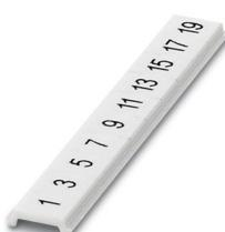
Zackband flach, Streifen, weiß, beschriftet, längs bedruckt: ungerade Zahlen 1-19, 21-39 usw. bis 81-99, Montageart: verrasten, für Klemmenbreite: 4 mm, Schriftfeldgröße: 5,15 x 4,15 mm, Anzahl der Einzelschilder: 10
