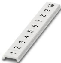
Zackband flach, Streifen, weiß, beschriftet, längs bedruckt: fortlaufende Zahlen 1 ... 10, 11 ... 20 usw. bis 91 ... 100, Montageart: verrasten, für Klemmenbreite: 4 mm, Schriftfeldgröße: 4,2 x 5,2 mm, Anzahl der Einzelschilder: 10
