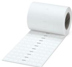
Etikett, Rolle, weiß, unbeschriftet, beschriftbar mit: THERMOMARK E.300 (D)/600 (D), THERMOMARK ROLL 2.0, THERMOMARK ROLL, THERMOMARK ROLL X1, THERMOMARK ROLLMASTER 300/600, THERMOMARK X1.2, Montageart: kleben, Schriftfeldgröße: 10 x 7 mm, Anzahl der Einzelschilder: 10000
