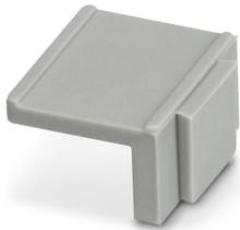
Geräte-Kennzeichnungsschild, Breite: 12 mm , Fläche: 12x8 mm z. B. für selbstklebendes Markierungsmaterial EML(10x7) R
