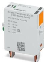
Überspannungsschutzstecker Typ 2, mit N-PE-Summenstromfunkenstrecke für VAL-SPP-Basiselement, thermisch überwacht, optische rot/grün Statusanzeige.
