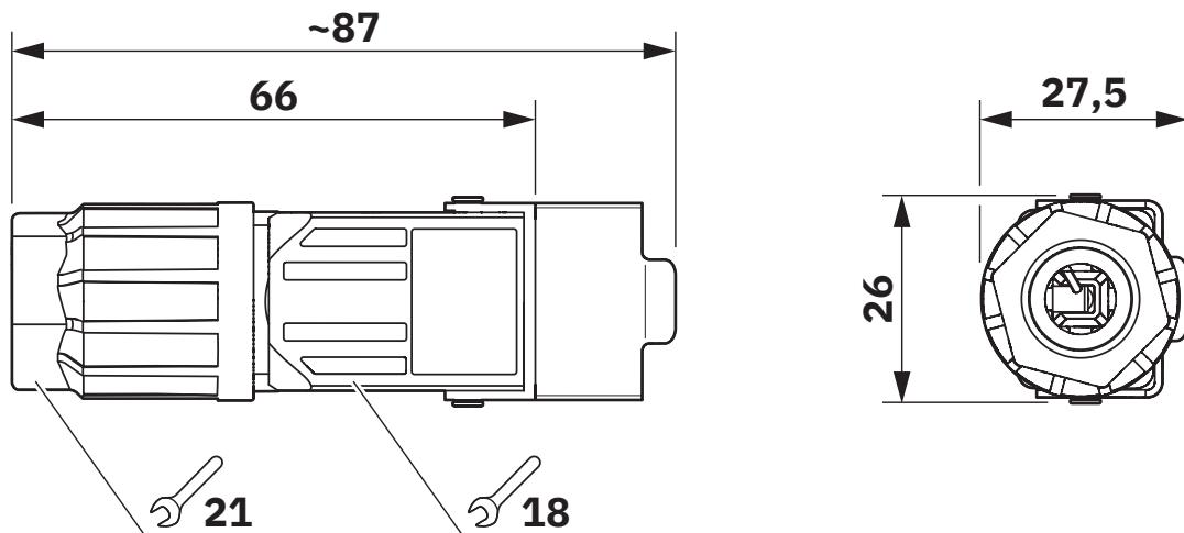
Länge = 66mm; bei bis zum Anschlag verschraubter Quickon-Mutter
