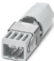
Steckverbinder, Produktfamilie: QPD, Anschlussart: IDC-Anschluss, Polzahl: 3+PE, 0,5 mm<sup>2</sup> ... 1,5 mm<sup>2</sup>, 400 V, 16 A AC, grau, mit einer QUICKON-Mutter, Leitungsaußendurchmesser: 7 mm ... 13 mm, Steckverbinder für den Motoranschluss von Raffstoren, Jalousien, Rollläden und Markisen
