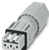
Steckverbinder, Produktfamilie: QPD, Anschlussart: IDC-Anschluss, Polzahl: 3+PE, 0,5 mm<sup>2</sup> ... 1,5 mm<sup>2</sup>, 400 V, 16 A AC, grau, mit einer QUICKON-Mutter, Leitungsaußendurchmesser: 7 mm ... 13 mm, Steckverbinder für den Motoranschluss von Raffstoren, Jalousien, Rollläden und Markisen
