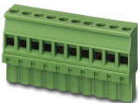
Leiterplattenstecker, Nennstrom: 12 A, Bemessungsspannung (III/2): 320 V, Nennquerschnitt: 2,5 mm<sup>2</sup>, Polzahl: 22, Rastermaß: 5 mm, Anschlussart: Schraubanschluss mit Zughülse, Farbe: grün, Kontaktoberfläche: Zinn
