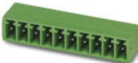
Grundgehäuse, Nennstrom: 8 A, Bemessungsspannung (III/2): 160 V, Polzahl: 10, Rastermaß: 3,81 mm, Farbe: grün, Kontaktobерfläche: Zinn, Montage: Löten
