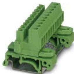
Tragschienenstecker, Nennstrom: 12 A, Bemessungsspannung (III/2): 320 V, Nennquerschnitt: 2,5 mm<sup>2</sup>, Polzahl: 14, Rastermaß: 5,08 mm, Anschlussart: Schraubanschluss mit Zughülse, Farbe: grün, Kontaktoberfläche: Zinn, Montage: Tragschiene
