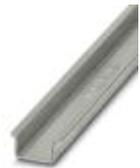
Tragschiene ungelocht, Standardprofil 2,3 mm, Breite: 35 mm, Höhe: 15 mm, nach EN 60715, Material: Stahl, verzinkt, dickschichtpassiviert, Länge: 2000 mm, Farbe: silberfarben
