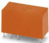
Steckbares Miniaturleistungsrelais, RT III gedichtet mit Leistungskontakten, 2 Wechsler, Eingangsspannung: 110 V DC, in Verbindung mit dem zugehörigen PLC-Sockel zugelassen nach ATEX/IECEX (Zone 2) und Ex-Zone Class I, Div. 2.
