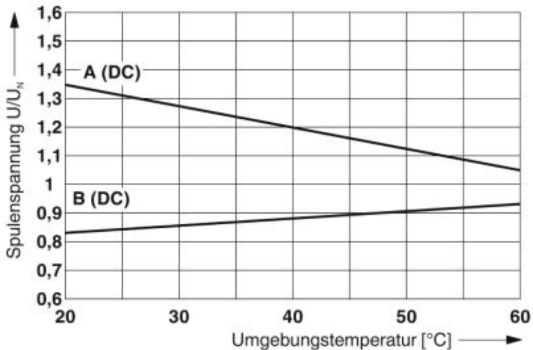
Kurve A: maximale Dauerspannung bei Grenzdauerstrom
