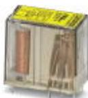
Sicherheitsrelais mit zwangsgeführten Kontakten gemäß DIN EN 61810-3, Kontaktausführung 2 Wechsler. Die Anforderungen für Typ A gemäß DIN EN 61810-3 werden erfüllt, wenn die Beschaltung als 1 Schließer / 1 Öffner erfolgt.
