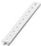
Zackband, Streifen, weiß, beschriftet, beschriftbar mit: CMS-P1-PLOTTER, längs bedruckt: fortlaufende Zahlen 1 ... 10, 11 ... 20 usw. bis 91 ... 100, Montageart: verrasten in hoher Schildchennut, für Klemmenbreite: 10,2 mm, Schriftfeldgröße: 10,15 x 10,5 mm, Anzahl der Einzelschilder: 10
