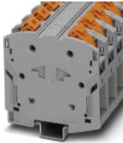
Durchgangsklemme, Anschlussart: Push-in-Anschluss, Querschnitt: 25 mm<sup>2</sup> - 95 mm<sup>2</sup>, AWG: 4 - 3/0, Breite: 25 mm, Farbe: grau, Montageart: NS 35/15
