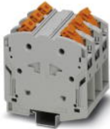
Klemmenblock, Anschlussart: Push-in-Anschluss, Polzahl: 3, Querschnitt: 25 mm 2 - 95 mm 2 , AWG: 4 - 3/0, Breite: 75 mm, Farbe: grau, Montageart: NS 35/15
