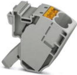
Abgriffklemme, Anschlussart: Push-in-Anschluss, Querschnitt: 0,5 mm<sup>2</sup> - 16 mm<sup>2</sup>, AWG: 20 - 6, Breite: 18,5 mm, Höhe: 34,7 mm, Farbe: grau, Montageart: auf Basiselement
