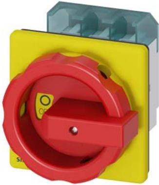
SENTRON, Lasttrennschalter 3LD, Not-Aus-Schalter, 3-polig, Iu: 63 A, Betriebsleistung / bei AC-23 A bei 400V: 22 kW, Frontbefestigt, Drehantrieb, rot/gelb, 4-Loch Befestigung der Handhabe
