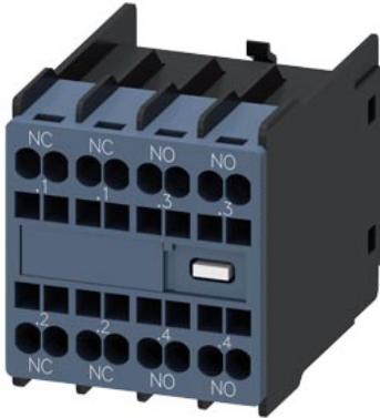
Hilfsschalter frontseitig, 2 S + 2 Ö Strombahn 1 Ö, 1 Ö, 1 S, 1 S für 3RH2 und 3RT2 Federzuganschluss .1/.2, .1/.2, .3/.4, .3/.4
