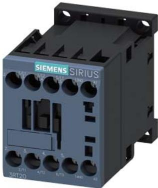
Leistungsschütz, AC-3 7 A, 3 kW / 400 V 1 S, AC 230 V, 50 / 60 Hz 3-polig,
