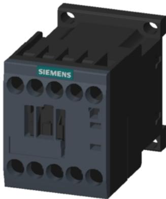
Leistungsschütz, AC-3 12 A, 5,5 kW / 400 V 1 Ö, AC 230 V, 50 / 60 Hz 3-polig, Baugröße S00 Schraubanschluss
