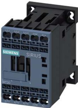
Leistungsschütz, AC-3 12 A, 5,5 kW / 400 V 1 Ö, DC 24 V 0,7-1,25\*US mit Suppressordiode integriert 3-polig, Baugröße S00 Federzuganschluss geeignet für SPS-Ausgänge nicht mit Hilfsschalter erweiterbar
