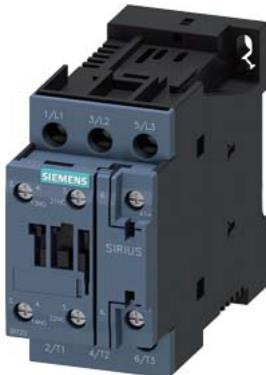
Leistungsschütz, AC-3 9 A, 4 kW / 400 V 1 S + 1 Ö, DC 24 V 3-polig,
