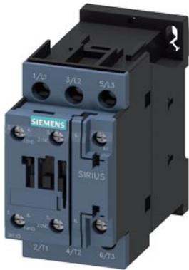
Leistungsschütz, AC-3 17 A, 7,5 kW / 400 V 1 S + 1 Ö, AC 230 V, 50 / 60 Hz, 3-polig, Baugröße S0, Schraubanschluss
