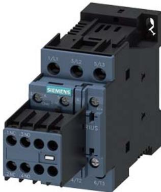
Leistungsschütz, AC-3 17 A, 7,5 kW / 400 V 2 S + 2 Ö, DC 24 V, 3-polig, Baugröße S0 Schraubanschluss Hilfsschalter lösbar
