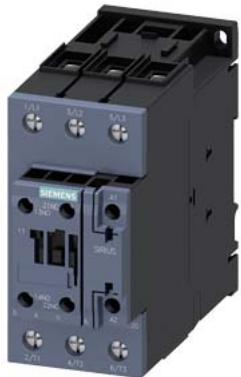
Leistungsschütz, AC-3 65 A, 30 kW / 400 V 1 S + 1 Ö, AC 230 V, 50 Hz 3-polig, Baugröße S2 Schraubanschluss
