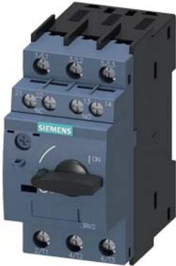
Leistungsschalter Baugröße S00 für den Motorschutz, CLASS 10 A-Auslöser 0,55...0,8 A N-Auslöser 10 A Schraubanschluss Standardschaltvermögen mit querliegenden Hilfsschaltern 1S+1Ö
