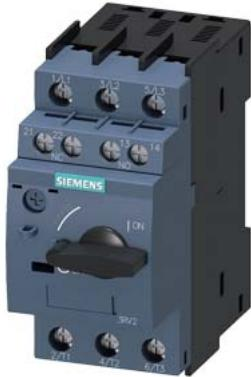
Leistungsschalter Baugröße S00 für den Motorschutz, CLASS 10 A-Auslöser 1,1...1,6 A N-Auslöser 21 A Schraubanschluss Standardschaltvermögen mit querliegenden Hilfsschalter 1S+1Ö
