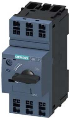
Leistungsschalter Baugröße S00 für den Motorschutz, CLASS 10 A-Auslöser 1,4...2 A N-Auslöser 26 A Federzuganschluss Standardschaltvermögen
