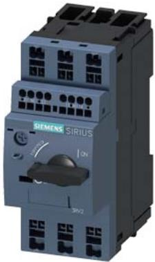
Leistungsschalter Baugröße S00 für den Motorschutz, CLASS 10 A-Auslöser 2,2...3,2 A N-Auslöser 42 A Federzuganschluss Standardschaltvermögen mit querliegenden Hilfsschalter 1S+1Ö
