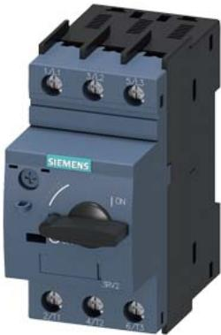
Leistungsschalter Baugröße S00 für den Motorschutz, CLASS 10 A-Auslöser 2,8...4 A N-Auslöser 52 A Schraubanschluss Standardschaltvermögen
