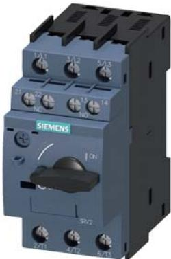
Leistungsschalter Baugröße S00 für den Motorschutz, CLASS 10 A-Auslöser 2,8...4 A N-Auslöser 52 A Schraubanschluss Standardschaltvermögen mit querliegenden Hilfsschalter 1S+1Ö
