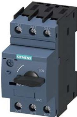
Leistungsschalter Baugröße S00 für den Motorschutz, CLASS 10 A-Auslöser 5,5...8 A N-Auslöser 104 A Schraubanschluss Standardschaltvermögen
