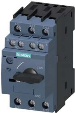
Leistungsschalter Baugröße S00 für den Motorschutz, CLASS 10 A-Auslöser 7...10 A N-Auslöser 130 A Schraubanschluss Standardschaltvermögen mit querliegenden Hilfsschalter 1S+1Ö
