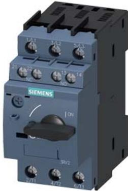
Leistungsschalter Baugröße S0 für den Motorschutz, CLASS 10 A-Auslöser 18...25 A N-Auslöser 325 A Schraubanschluss Standardschaltvermögen mit querliegenden Hilfsschalter 1S+1Ö
