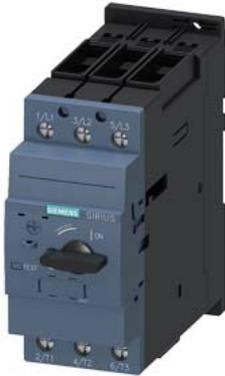
Leistungsschalter Baugröße S2 für den Motorschutz, CLASS 10 A-Auslöser 22...32 A N-Auslöser 416 A Schraubanschluss Standardschaltvermögen
