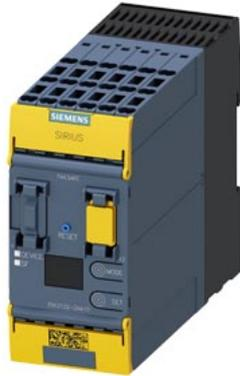
SIRIUS Sicherheitsschaltgerät Grundgerät 3SK2 Reihe 20 F-DI, 4 F-DQ, 2 DQ, 24 V DC parametrierbar über SIRIUS Safety ES 45 mm Baubreite Federzuganschluss (Push-In) bis SILCL 3 (DIN EN 62061) bis Performance Level E (ISO 13849-1) Ausgangserweiterungen 3SK1 und fehlersichere Motorstarter 3RM1 über Geräteverbinder anschließbar
