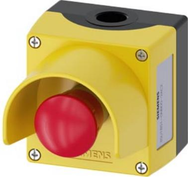
Gehäuse für Befehlsgeräte, 22 mm, rund, Gehäusematerial Metall, Gehäuseoberteil gelb, mit Schutzkragen, 1 Befehlsstelle Metall, A=NOT-HALT-Pilzdrucktaster rot, 40 mm, drehentriegelt, 1Ö, 1Ö, Schraubanschluss, Bodenbefestigung, oben und unten je 1xM20
