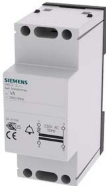
Klingeltransformator, 14VA Primär 230-240V AC, 50Hz, Sekundär 8V, 12V, 24V AC mit PTC-Sicherung, 2TE++
