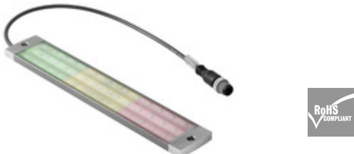
Die WIL-LED Leuchte mit Rot/Gelb/Grün: Nur 8mm hohe LED Leuchte für 24V DC mit sehr hoher Lichtausbeute und hoher Lebensdauer (Größer 60 000h). Sehr robuste Bauweise, durch Vollverguss und Metallgehäuse - waserdicht (IP67). Durch seine 3 Lichtfarben als Signalanzeige geeignet. Optional mit M12 Anschluss sehr leicht anschließbar. Durch die geringe Stromaufnahme reicht ein kleines Netzteil mit 24V zum Betrieb.
